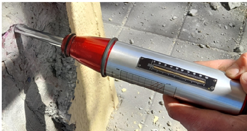
Obr. 4 Použití tvrdoměrné kladívko typ Schmidt N
